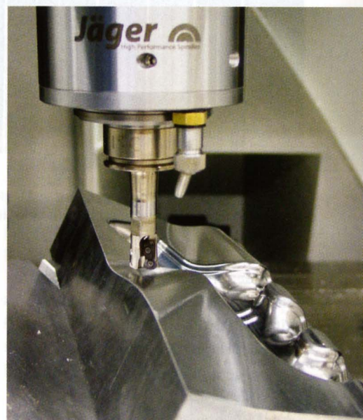
2 Formkontur schrappen: Material 1.2343, Härte 54 HRC, Messerkopf Durchmesser 16 mm, Drehzahl 5350 min -1 , Vorschub 4280 mm/min
