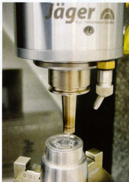
1 Münzpfaffe gravieren: Material 1.2379, Härte 58 HRC, HM-Rautenfräser Durchmesser 0,15 mm, Drehzahl 35 000 min -1 , Vorschub 350 mm/min
