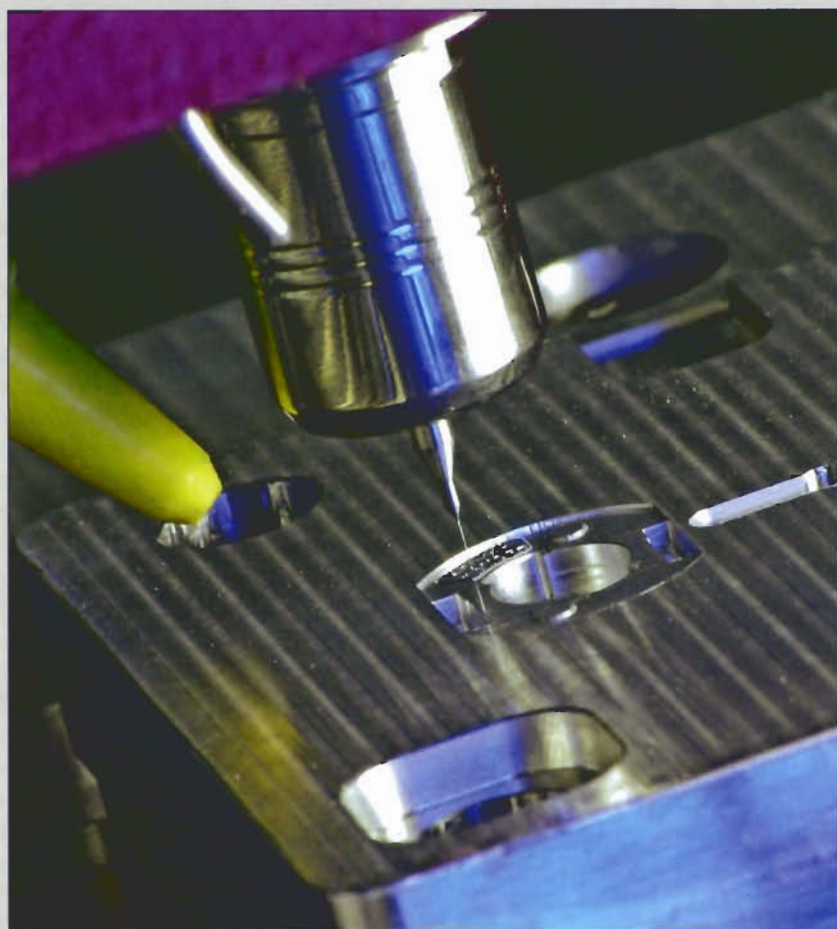
Bei der Zerspantung von Formplatten aus hochfestem Aluminium garantiert die High-Speed-Werkzeugaufnahme sehr hohe Zuverlässigkeit und Prozesssicherheit
