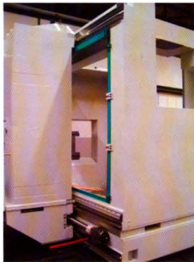
Verwindungssteifer Maschinenständer, in X-Richtung 2.000 mm verfahrbar.
