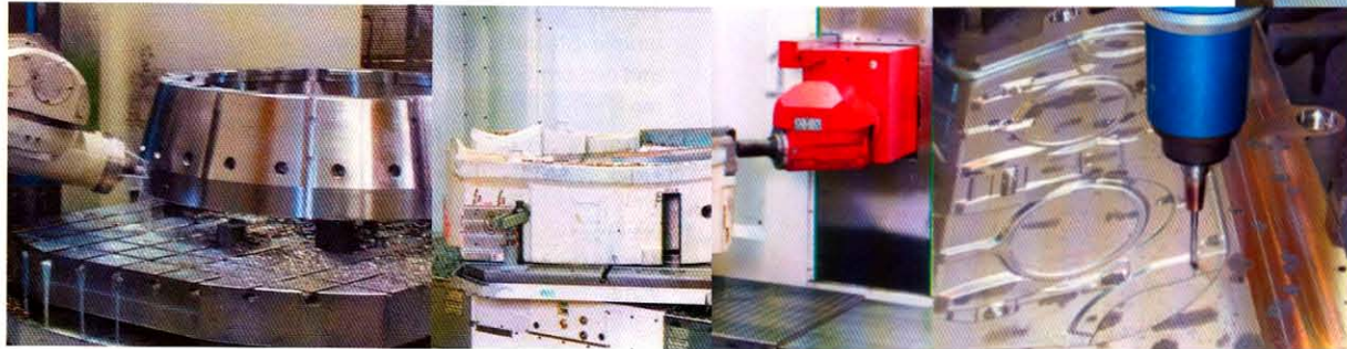
Fünfseitenbearbeitung auf dem Universal-BAZ UniSpeed 5.
